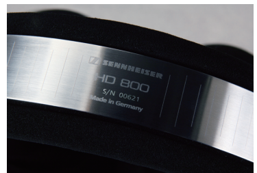
ヘッドバンド上部にはフラッグシップモデルにふさわしく、一台ごとにシリアルナンバーが刻印される。ヘッドバンドは金属とプラスチックによるサンドイッチ構造となっていて、優れた減衰特性により音に有害な振動を本体部に伝えない。
