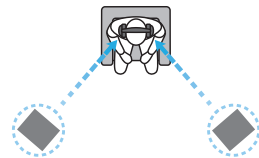
ドライバーユニットは、耳に対して真横ではなく、角度をもって取り付けられている。ちょうど下図のように、斜め前方に置いたスピーカーから音が耳に届くことになり、自然な音場感が再現できる。
