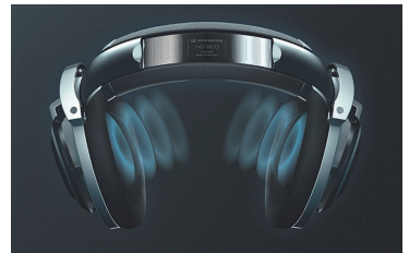
リング形状とすることで大口径化と振動板の正確なコントロールという相反する要素を両立させたHD800のφ56mmドライバー。40mmボイスコイル、50mmマグネットとともにヘッドフォン用としては世界最大。
