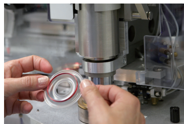
HD800のドライバーユニットはレーザー解析技術を駆使してミクロン単位の精度で設計される。
