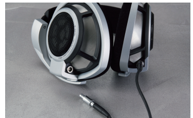
ケーブルは着脱式となっている。ヘッドフォンをつけたまま立ち上がったとき、ケーブルが何かに引っかかって外れることで負荷を逃して断線を防ぐ仕組み。また、HD650同様、高音質をうたった交換ケーブルが発売されるかもしれない。
