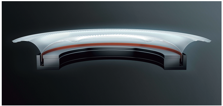
リング形状とすることで大口径化と振動板の正確なコントロールという相反する要素を両立させたHD800のφ56mmドライバー。40mmボイスコイル、50mmマグネットとともにヘッドフォン用としては世界最大。
